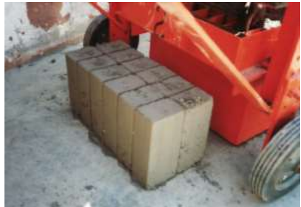
図-15 カラハリ砂漠砂ブロック製造機械 (ブロックサイズは長さ:L=0.300m、幅:W=0.115m、高さ:H=0.150m、1cycle 12 blocks 製作可能)
